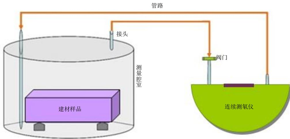
图A.1 建筑材料氡射气系数测量系统简要示意图
